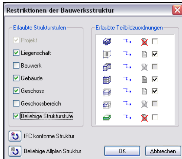
Abbildung 7: Überprüfen der Bauwerksstruktur auf IFC Konformität
